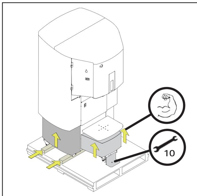
Deslice hacia arriba los paneles laterales inferiores y coloque la máquina sobre la plataforma. Coloque las aletas hacia atrás, debajo de la máquina, y adose la brida de transporte en el frente. Desprenda el soporte para latas a fin de evitar daños.
