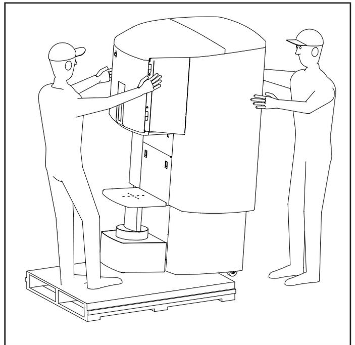
Retire la máquina de la plataforma.
