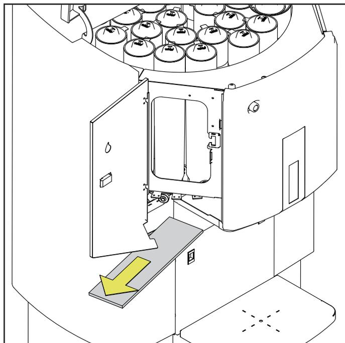
Abra la puerta del lado izquierdo. Retire la pieza de espuma de la placa del interruptor.
