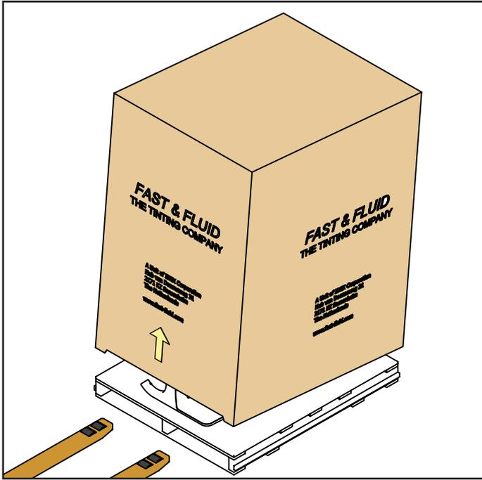
Coloque la plataforma de transporte cerca de la ubicación definitiva de la máquina. Retire la caja de cartón, el envoltorio plástico y las piezas accesorias.
