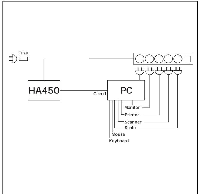
Conecte el dispensador según se indica en la imagen que aparece arriba.
