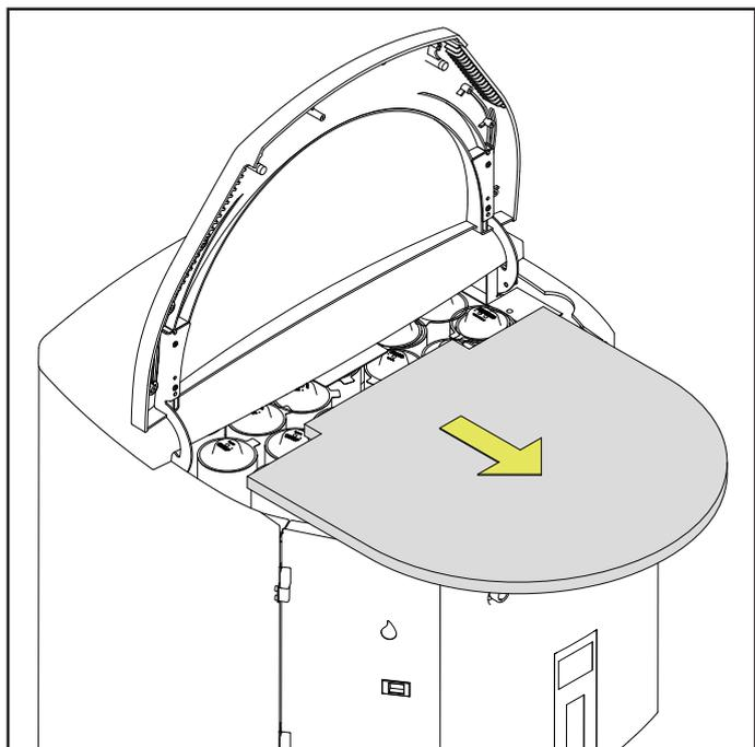
Retire la cinta azul y abra la cubierta superior. Retire la espuma de los cartuchos.
