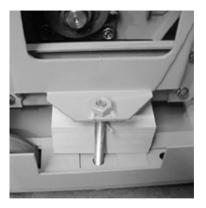
Al quitar los tornillos, se puede sacar el taco de madera que mantenía fijo el armazón.
