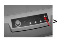
Para interrumpir el programa de mezcla, pulse el botón de parada. La parada de emergencia únicamente se debe usar en caso de una auténtica emergencia.
