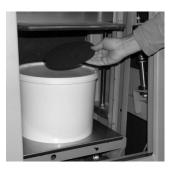
Coloque el disco de relleno sobre la tapa para prevenir desplazamientos durante la operación.
