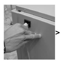
Desenchufe la máquina y extraiga la bandeja de fusibles.
